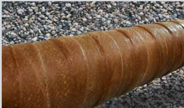
La envoltura anticorrosiva Wax Tape® HT-3000 de Trenton para altas temperaturas seguirá funcionando de manera efectiva a temperaturas continuas de operación de hasta 230°F (110°C). Cuando se utilice en superficie o expuesta, se recomienda la utilización de un refuerzo, como el MCO® 110 de Trenton.
