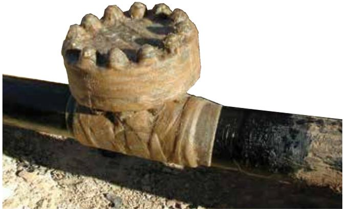
*Wax-Tape #1 Trenton se aplica en zonas enterradas, la misma protege accesorios, y es compatible a cualquier superficie irregular tales como accesorios y la protección catódica.*
